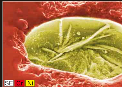
Element-MAP eines Schichtdefektes
