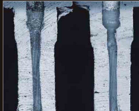
Element-MAP eines Schichtdefektes
