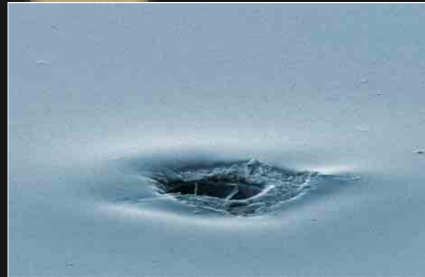
Fremdkörper in einer geätzten Oberfläche
