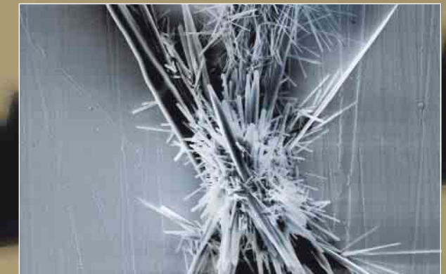
Rückstand auf einer galvanisch vergoldeten Oberfläche
