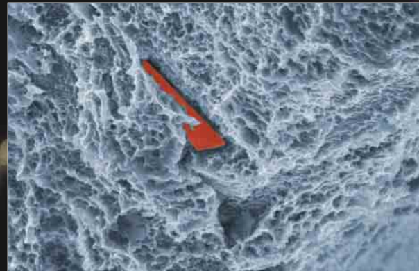
Fremdkörper in einer geätzten Oberfläche
